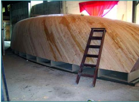
En la siguiente fotografía podemos ver la segunda capa del forro, colocada en sentido transversal. Esta capa es de madera de pino gallego seleccionado, de cinco milímetros de espesor. Como todas las capas está pegada por medio de saturación de resina epoxi.
