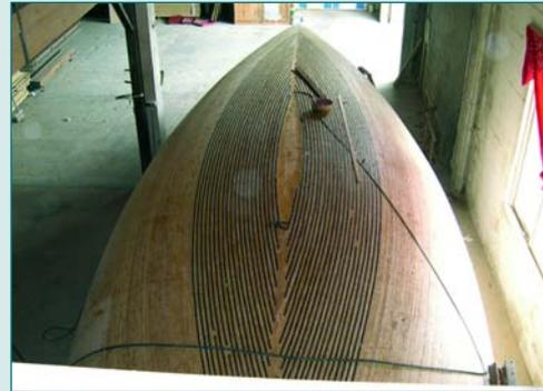
En la siguiente fotografía podemos ver la tercera capa del forro visto la terminación de la misma rematándose, y las cintas que se pueden apreciar, son destinadas para arrancar las grapas que sirven para sujetar la capa a la base.
